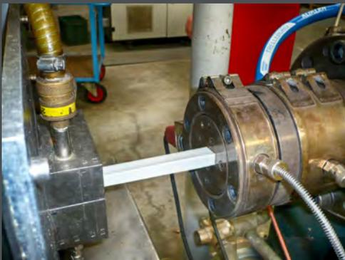
L'extrusion thermoplastique est une technique de transformation d'une matière Dry Blend ou Compounds (poudre ou granulés) sous contraintes thermiques et mécaniques, en un produit continu ayant un profil déterminé obtenu par forçage à travers une filière.
